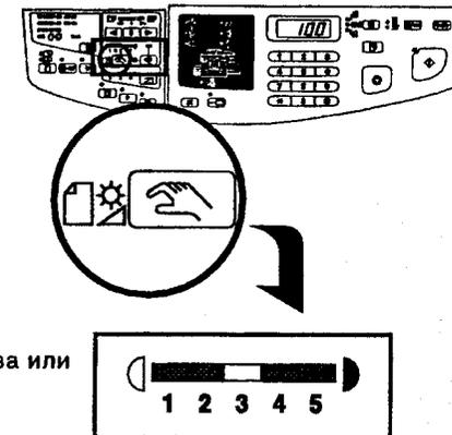
**ПРИМЕЧАНИЕ** После настройки контраста сканирования сделайте еще один мастер для того, чтобы эта регулировка действовала при печатании последующих печатных копий.
