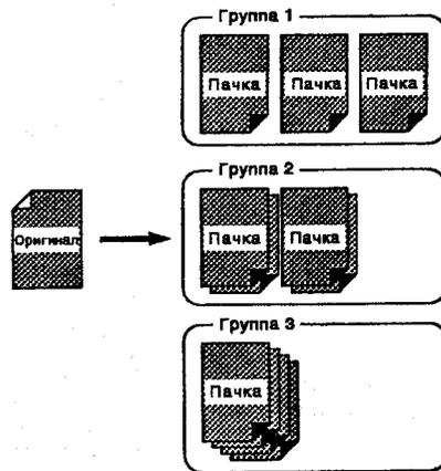
Если в устройство автоматической подачи оригиналов закладывается более чем один оригинал (до 10 листов) при включенной функции автоматического печатания, в отношении каждого оригинала полностью выполняется установленная программа до тех пор, пока все оригиналы не будут отпечатаны и рассортированы по группам, указанным в такой программе.
