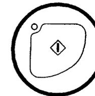
При нажатии и удержании кнопки R-8y (ВСЕ СБРОСИТЬ) в течение свыше одной секунды программа очищается.
