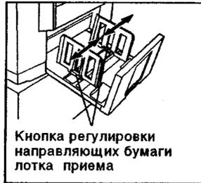
Кнопка регулировки направляющих бумаги лотка приема
